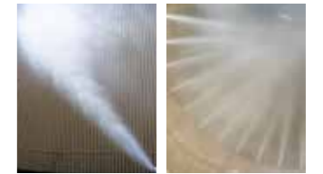
通过多喷嘴喷枪向喷淋室内喷入雾化水
